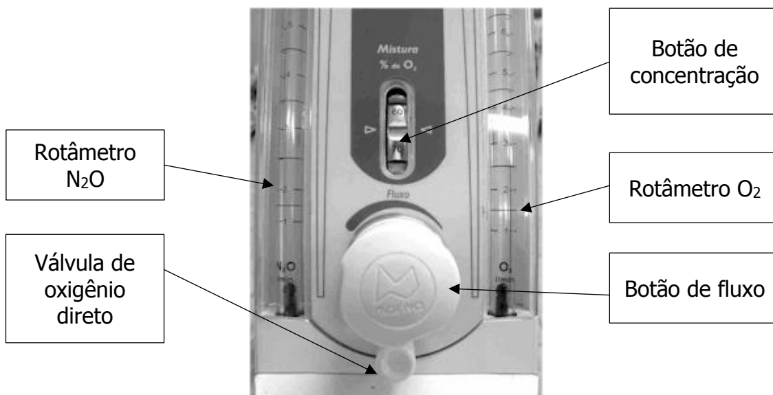
Figura 2 – Painel frontal do bloco de rotâmetros
